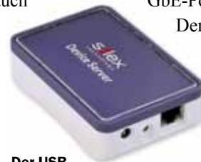
Der USB-Device-Server SX-DS-4000U2 von Silex verfügt über zwei USB- und einen GbE-Anschluss.
